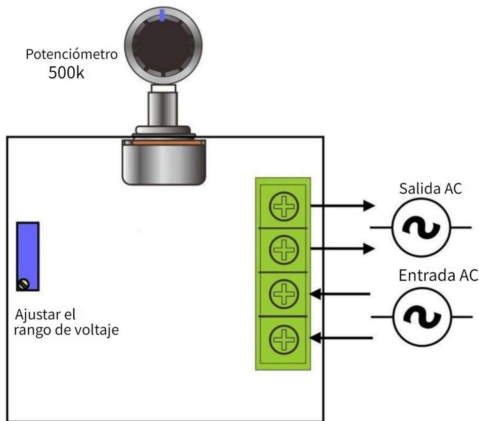
Régulateur de vitesse de moteur à courant alternatif 2000W 50-220V 25A, régulateur de tension réglable
